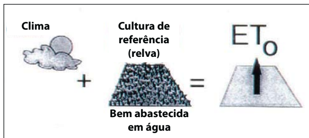
Representação esquemática dos factores envolvidos na estimativa da evapotranspiração de referência (ET 0 ).
