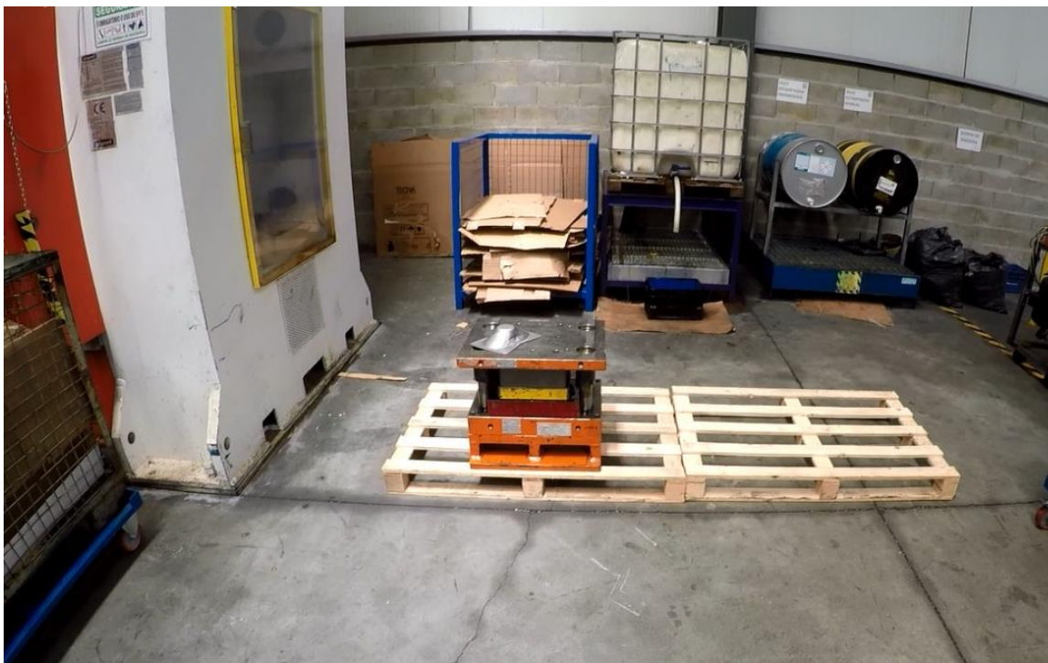
Figura 22 - Posicionamento prévio do molde da nova referência ao lado da prensa Fonte: O autor
