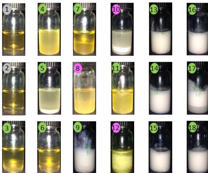
Figura A- 23: Diagrama de fases e registo fotográfico do aspeto das misturas individuais usadas na construção do diagrama pseudoternário (sistema: água + azeite + Tween 80/Span 80 (1:1), estudando o efeito da temperatura a 60°C).
