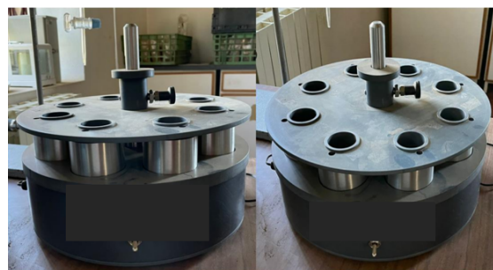
Fig. 2 – Equipamento de agitação e crivagem em húmido de amostras para determinação da Estabilidade da Agregação.
