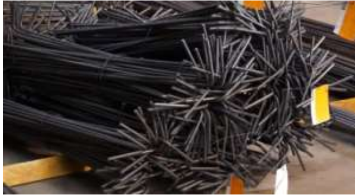
Figura 13 - Aço cortado e dobrado na indústria Fonte: Ferro Norte
