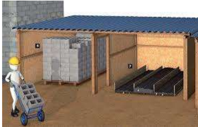
Figura 6 - Exemplo de armazenamento de materiais em obra Fonte: SAURIN; FORMOSO, 2006
