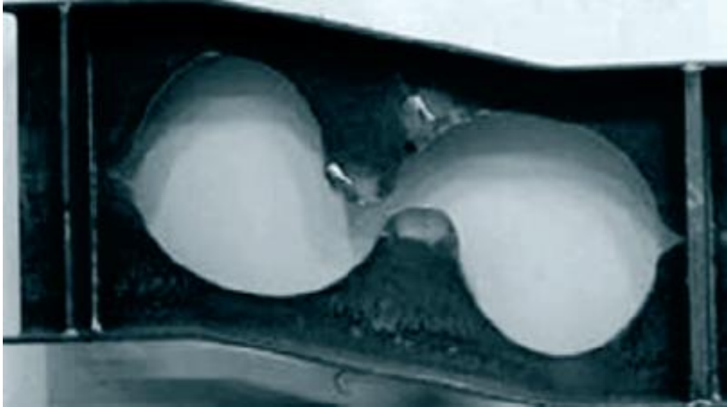
Figura 2.15: Colapso da solda entre as aberturas, [18].
