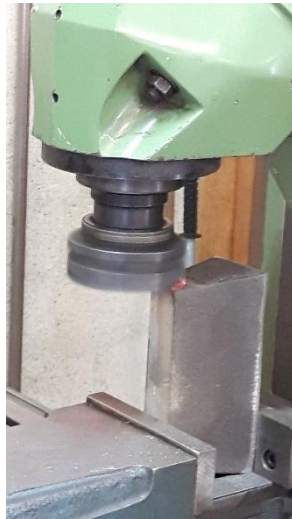
Figura 22-Realização dos apoios na fresadora de topo.
