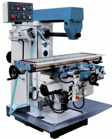
Figura 4-Exemplo de uma fresadora horizontal.[26].
