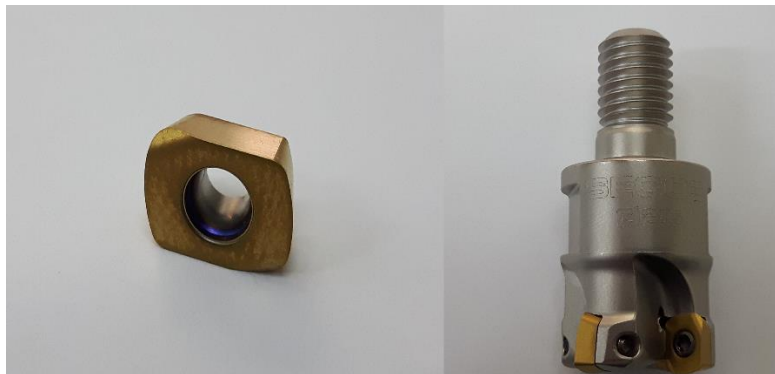
Figura 26- Pastilhas fornecidas pela Seco e a sua devida colocação na ferramenta.
