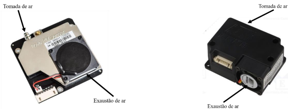
Figura 7- Sensores SDS011 e SEN0177 responsáveis pela quantificação de material particulado.
