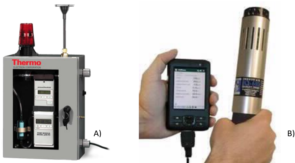
Figura 13- Equipamentos utilizados como “referência” na avaliação do protótipo: A) Thermo Scientific ADR-1200S e B) GrayWolf IAQ610.
