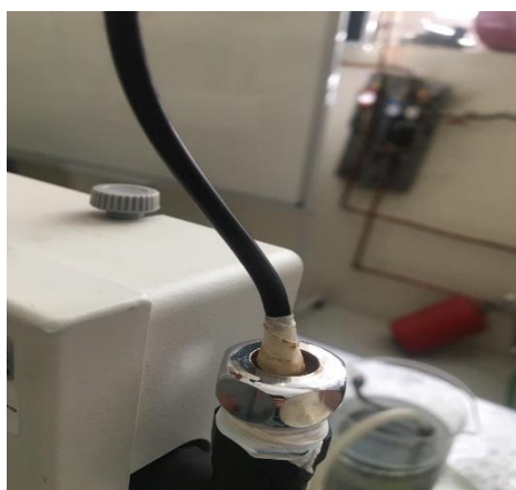
Figura 4.7 - Implementação dos sensores DS18B20 à saída do coletor.
