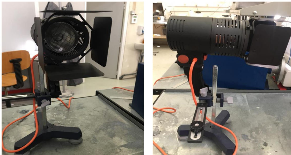
Figura 3.6 – Projetor com lâmpada halógena usada para simular a radiação solar.
