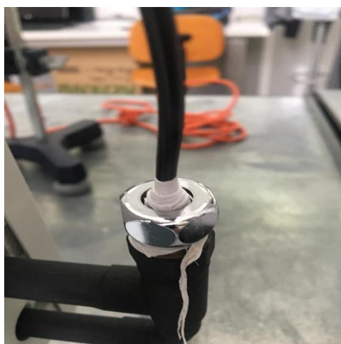
Figura 4.5 - Implementação do sensor DS18B20 à entrada do coletor.
