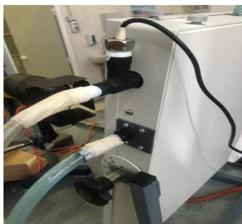
Figura 4.7 - Implementação dos sensores DS18B20 à saída do coletor.
