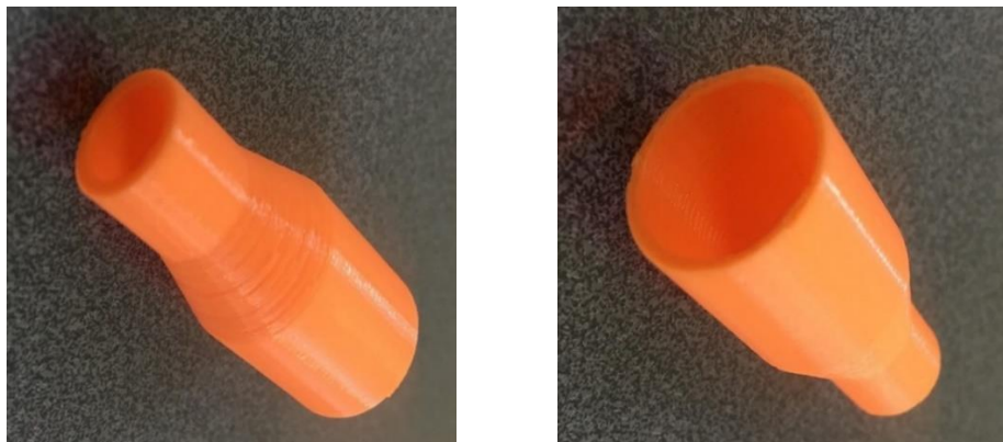
Figura 3.10 - Adaptador impresso na impressora 3D FDM.
