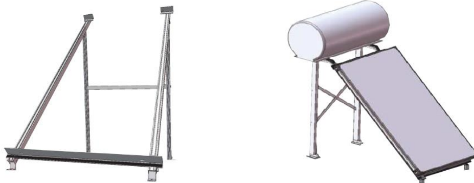
Figura 2.12 - Estrutura para superfície plana [21].
