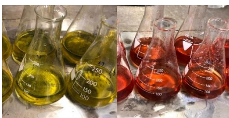
Figura 5 - Processo de titulação do carbono microbiano.
