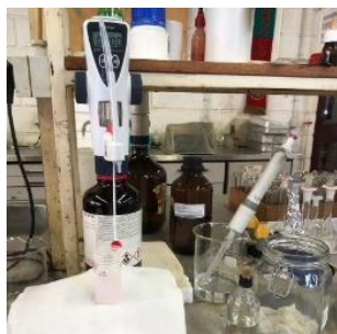
Figura 7- Titulação das amostras com solução de HCl 0,5N.
