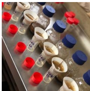
Figura 4 – Processo de filtração das amostras com filtros Watman n° 42 .
