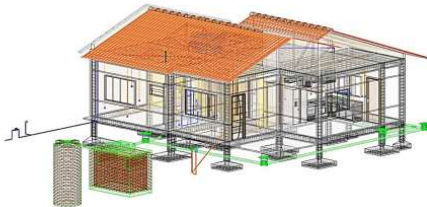
Figura 32 - edificação final com os projetos interdisciplinares integrados.
