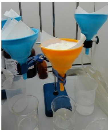
Figura 3.16: Polímero colocado em funis num suporte durante o processo de lavagem e secagem.
