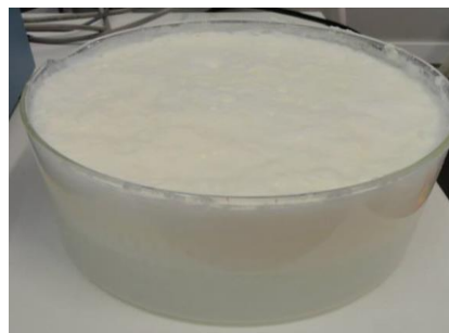
Figura 3.15: Produto P6, PCM encapsulado com RAFT1 (Octadecano 99%) retirado do reator.
