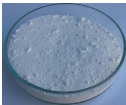
Figura 3.19: Produto P4 final (Octadecano 90% encapsulado).
