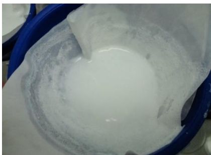
Figura 3.17: Processo de lavagem do produto P8 (Sem PCM com RAFT1).
