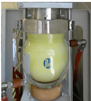
Figura 3.13: Funcionamento do reator 5100 durante procedimento experimental com RAFT.
