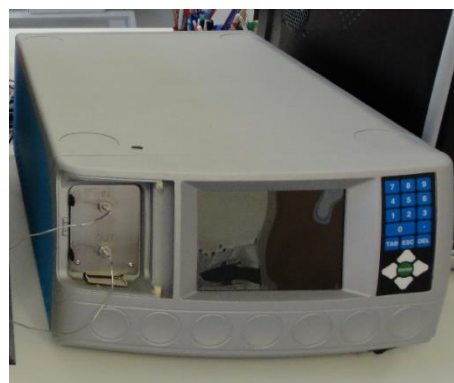
Figura 4.6: Detetor de dispersão de luz Wyatt Tecnologia DAWN8+ HELEOS 658 MALLS detector.
