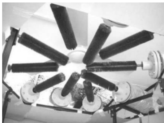
Figura 2.7: Tubos de PCM impregnados de PCM localizados debaixo da ventoinha [36].
