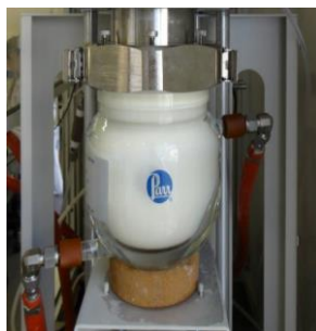
Figura 3.10: Funcionamento do reator 5100 durante procedimento experimental.
