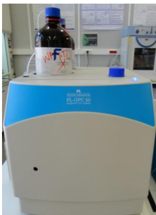
Figura 4.5: Sistema de GPC PL-GPC-50.
