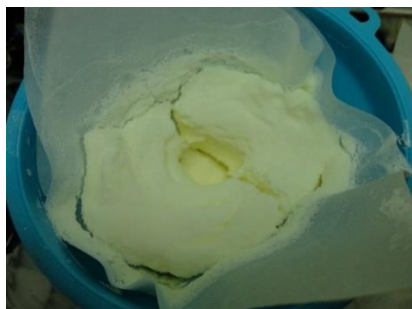
Figura 3.18: Processo de lavagem do produto P9 (Octadecano 99% encapsulado com RAFT3).
