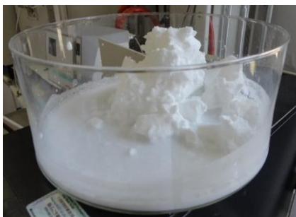
Figura 3.14: Produto P1, PCM encapsulado (Parafina) retirado do reator.
