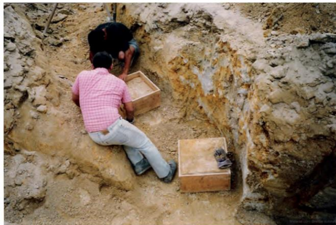
Figura 21 - Coleta de amostras indeformadas por acesso direto. (Fernandes, 2016)
