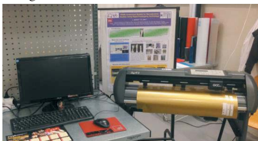
Fig. 4 Equipamento utilizado para corte das geometrias para fabricação do molde.
