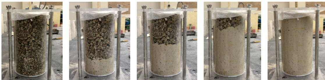
Figura 25 – Ensaio de injetabilidade da calda CCOM em corpo de prova preenchido com granito.
