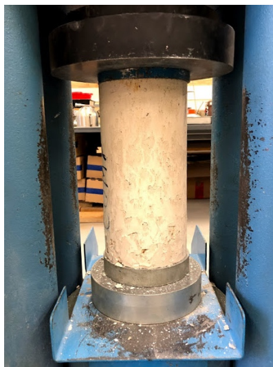
Figura 23 – Ensaio de compressão uniaxial realizado em corpo de prova composto por pedra e calda.
