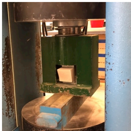
Figura 18 – Realização do ensaio para determinação da resistência à compressão.
