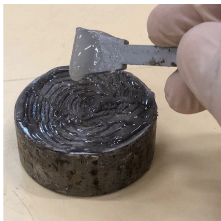
Figura 19 – Aplicação da cola bicomponente na pastilha metálica.
