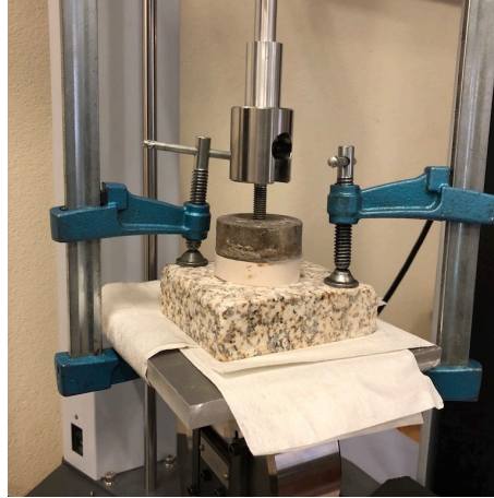
Figura 21 – Execução do ensaio de aderência.
