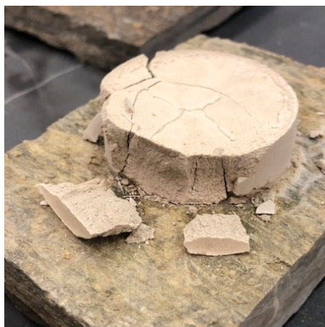
Figura 20 – Corpo de prova que se rompeu durante a operação de desmoldagem.
