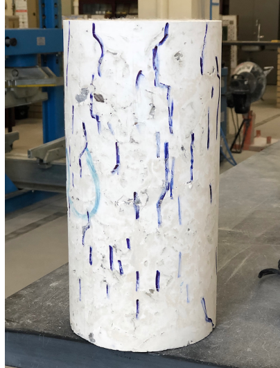
Figura 35 – Fendas verticais e destacamentos observados nas faces dos corpos de prova.
