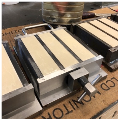
Figura 15 – Execução dos corpos de prova para o ensaio de flexão e compressão.
