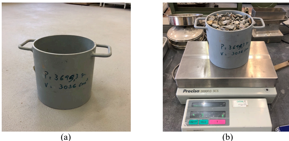
Figura 9 – Determinação da massa unitária: (a) recipiente utilizado; (b) pesagem do recipiente e do agregado.
