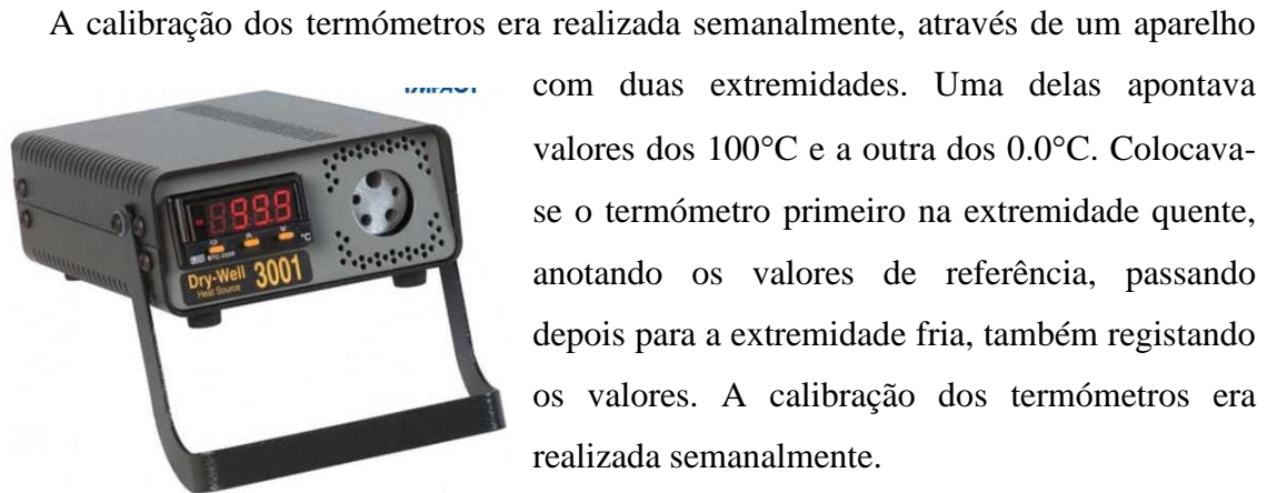
Figura 2- Equipamento de calibração de termômetros. (Fonte: ETI 3003 Series Dry-well Heat Source Calibrators | Gem Scientific )
