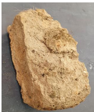
Figura 48 - Bloco de terra compactada sem alterações
