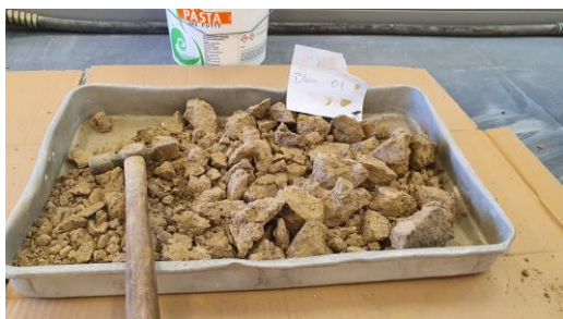
Figura 34 - Quebra do bloco de terra compactada
