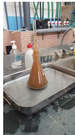
Figura 33 - Picnômetro depois de atingido a temperatura ambiente e acrescentado água até o traço de referência
