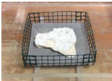
Fig. 1 – Aspecto geral de um provete colocado sobre o cesto de rede metálica com a tela de geotêxtil utilizados neste ensaio
