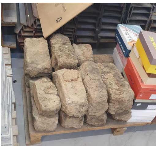
Figura 31 - Blocos de Terra a serem ensaiados
