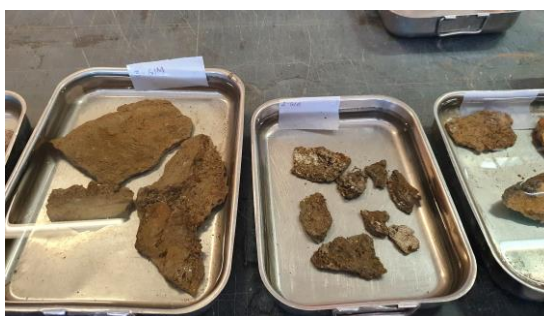
Figura 55 - Saturação das amostras
