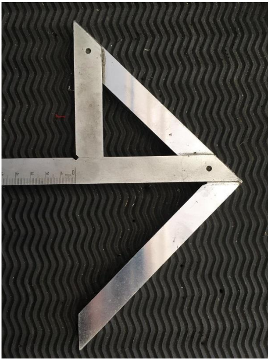
Figura 20 – Esquadro de centro utilizada na divisão das 4 partes iguais do volante
