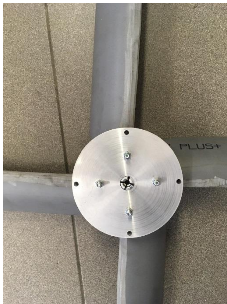
Figura 25 – Pás fixadas com apenas 1 parafuso
