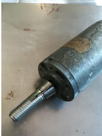
Figura 28 – Motor com o parafuso de encaixe no eixo de rotação
