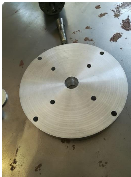
Figura 22 – Volante de rotação, pronto para aplicação no sistema
