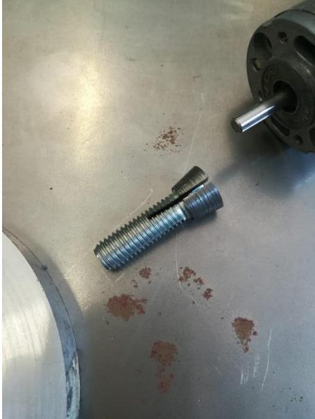
Figura 23 – Adaptação para unir volante de rotação no eixo do motor.
