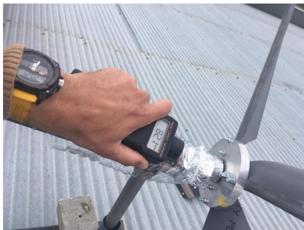
Figura 41 – Medição do regime do rotor (RPM)
