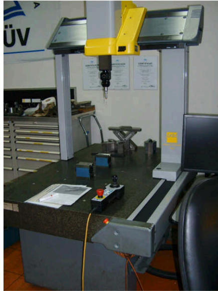
Figura 14 - Máquina tridimensional de medição BROWN & SHARPE MISTRAL CNC.
