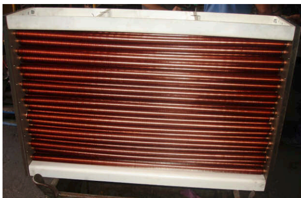
Figura 13 - Permutador de calor.
