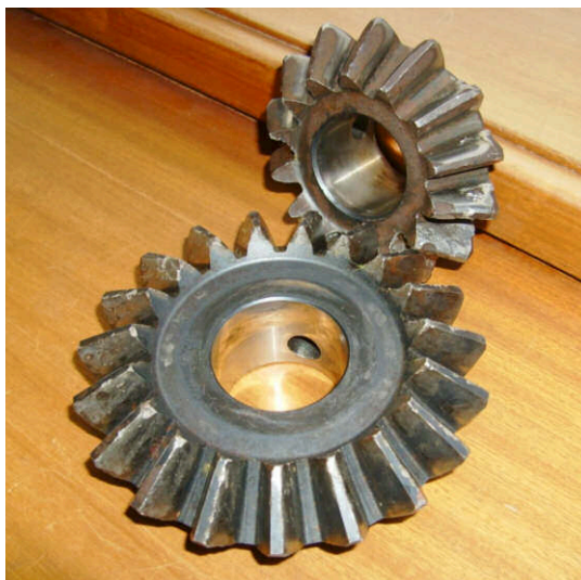
Figura 5 - Conjunto cónico-recto com fracturas.
