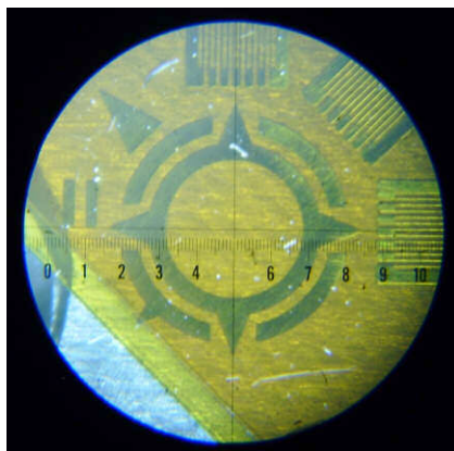
Figura 37 – Imagem obtida na lupa do centro da roseta concêntrico com o engenho de furar.
