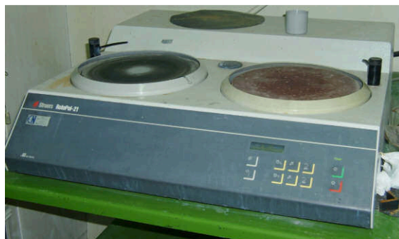
Figura 46 - Equipamento de polimento (Struers RotoPol-21).
