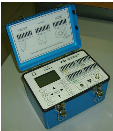
Figura 39 - Equipamento de leitura e gravação de tensões.
