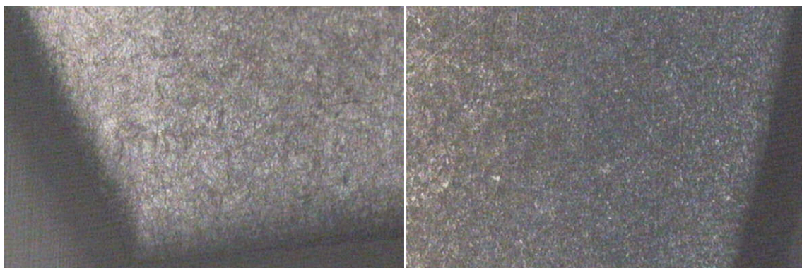
Figura 56 - Visualização da profundidade da camada de cementação.
