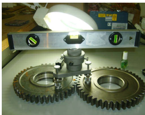
Figura 36 - Alinhamento do RS-200 com a estrutura em estudo.
