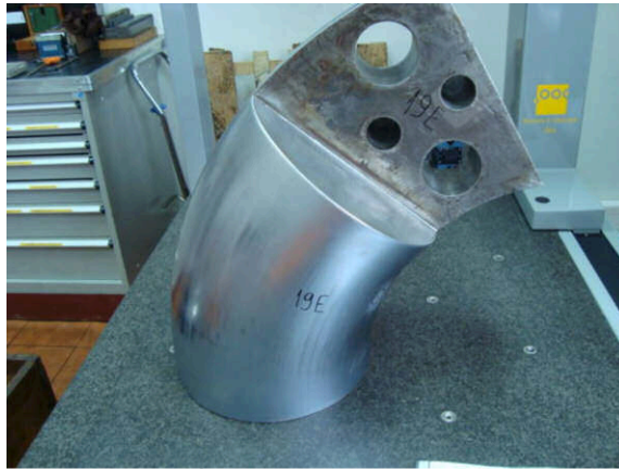
Figura 16 - Êmbolo dos servomotores tóricos.
