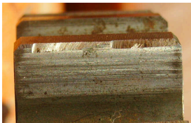
Figura 54 - Aparência do dentado da engrenagem devolvida.
