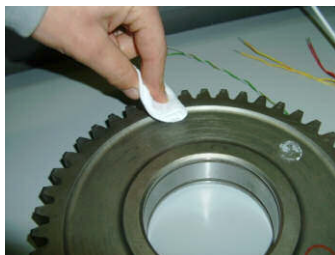
Figura 30 - Limpeza da superfície antes da colagem.
