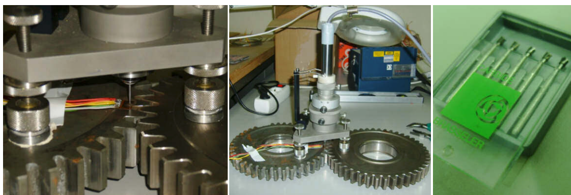
Figura 38 - Fresa centrada para início das medições, sistema de furação, fresas usadas.
