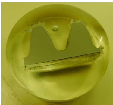
Figura 48 - Amostra polida pronta para se proceder ao ataque químico.
