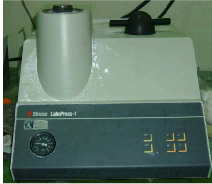
Figura 45 - Equipamento de preparação das amostras (Struers LaboPress-1).
