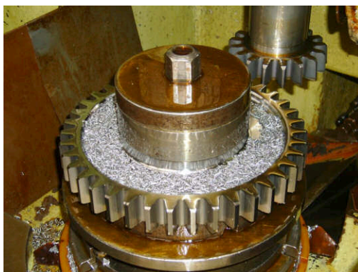
Figura 21 - Mecanismo de geração do dentado.
