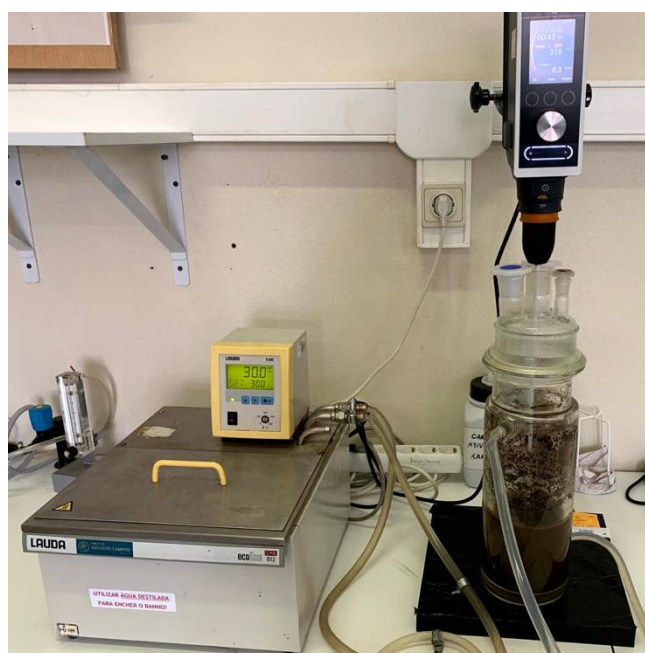
Figura 1 – Instalação experimental usada nos ensaios de Fenton.
