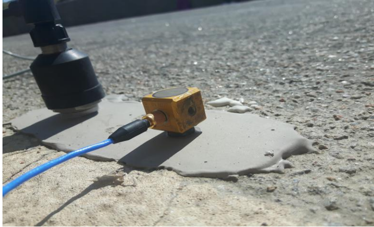
Figura 12 - Detalhe do acoplamento dos acelerômetros utilizando argamassa de secagem rápida Fonte: Autoria própria
