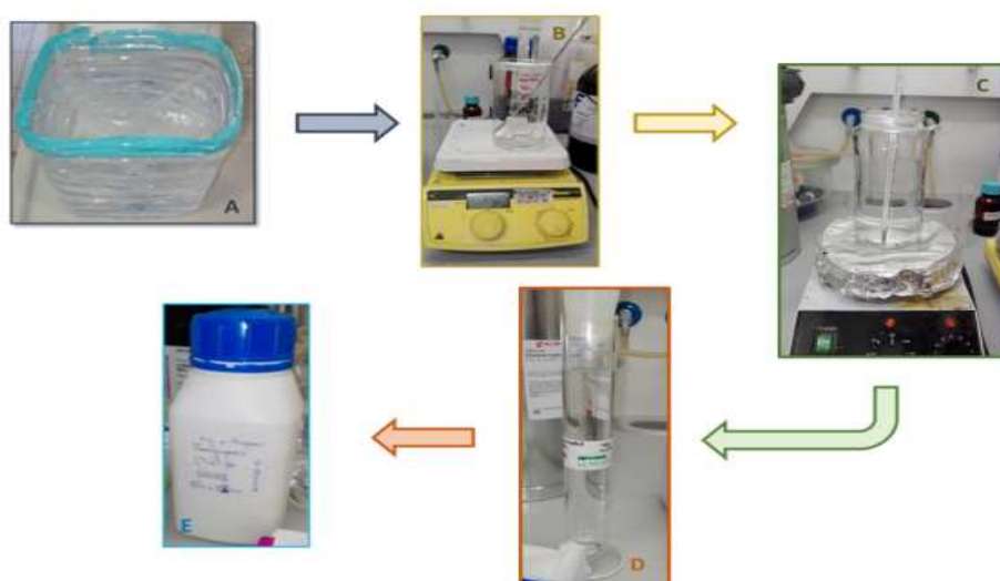
Figura 7: Procedimento experimental para preparação de membranas de diálise. A: lavagem de tubos; B: tratamento com sulfureto de sódio a 80 °C; C: lavagem com água quente (60 °C); D: acidificação com ácido sulfúrico; E: armazenamento.
