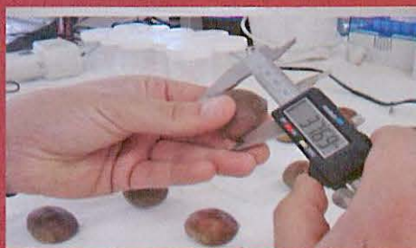
6 - caracterização das dimensões, com craveira
