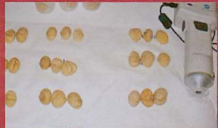
5 - castanhas descascadas e colorímetro (controlo de cor após irradiação)
