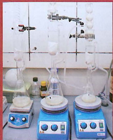
7 - caracterização química após irradiação (colunas de extração de compostos)
