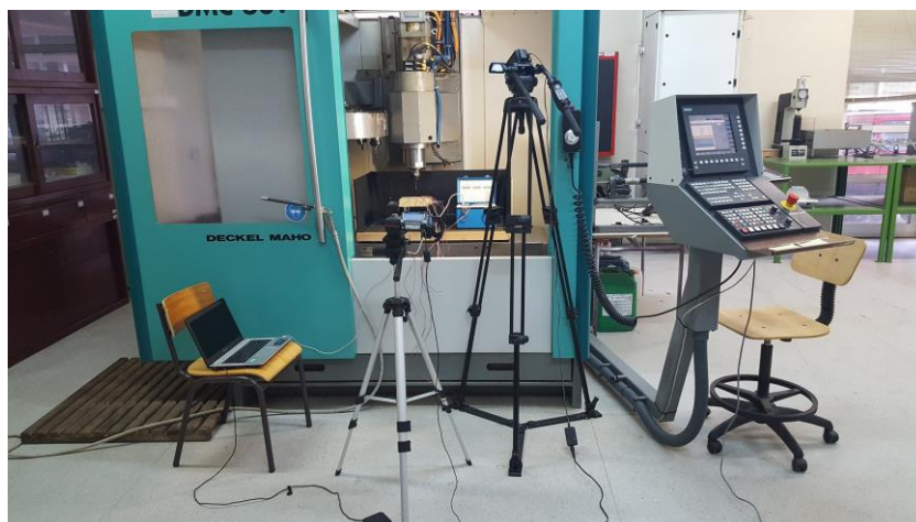
Figura 6- Setup experimental utilizado na furação
