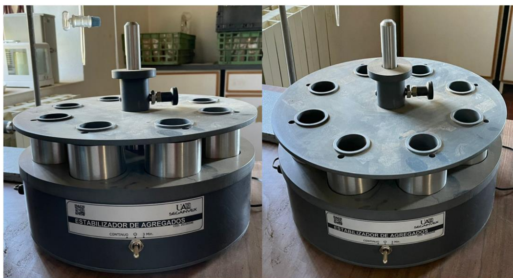
Figura 18 - Equipamento Estabilizador de Agregados, cedido pela Universidade Autónoma de Madrid para este trabalho de investigação IPB/UAM.
