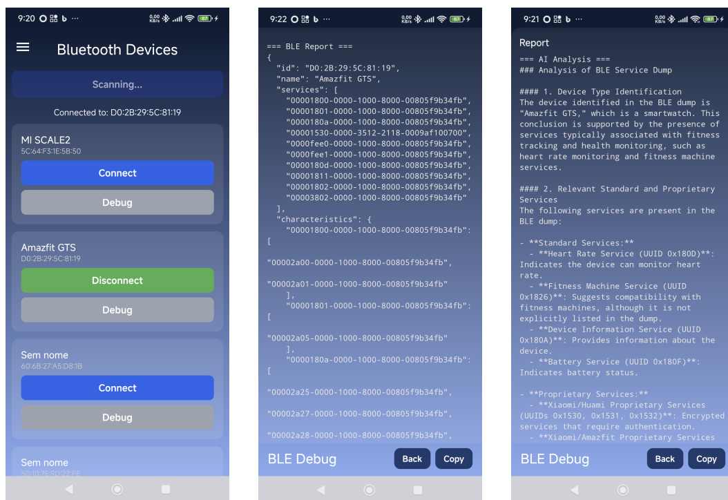
Figura 4.8: Interfaces BLE: deteção de dispositivos (esquerda), relatório técnico dos serviços identificados (centro) e análise automática dos UUIDs (direita).
