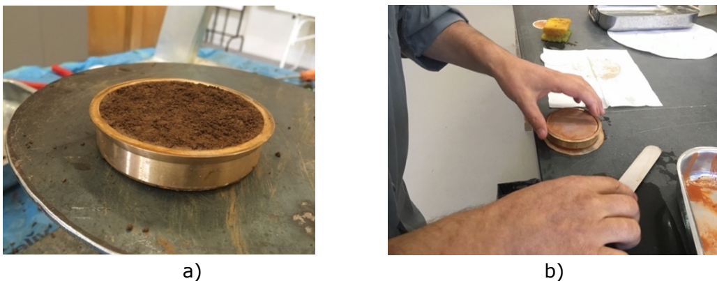
Figura 4.6 a) Provete relativo a uma amostra indeformada, solo A; b) Provete relativo a uma amostra remexida, solo B.
