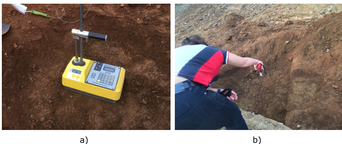
Figura 4.12 a) Gamadensímetro; b) Medição a laser realizada.
