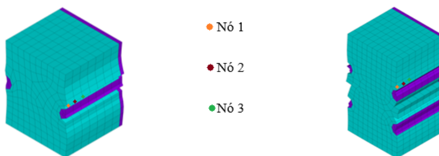
Figura 22 - Localização de três nós a fim de retirar os valores da temperatura. À esquerda para as ligações A e B, e à direita, para as ligações C e D
