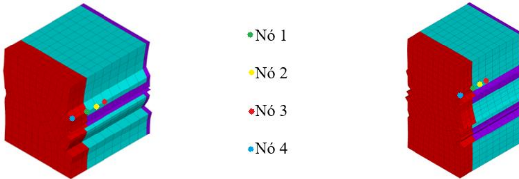
Figura 30- Localização de três nós a fim de retirar os valores da temperatura. À esquerda para as ligações A e B, e à direita, para as ligações C e D
