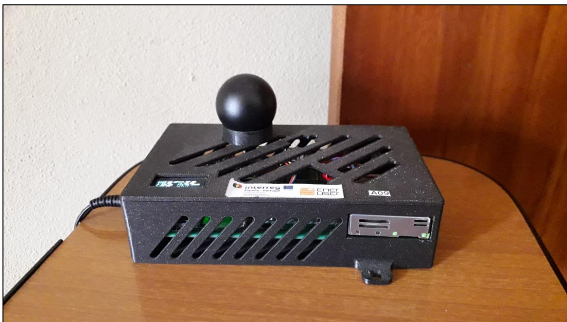
Figura 8: Miniestação de monitorização do ambiente interno.
