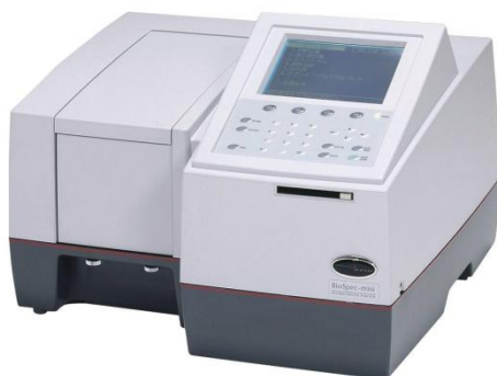
Figura 3.9: Espectrofotômetro (Shimadzu, Modelo: UV mini -1240) utilizado para a determinação do Azoto Total, do Fósforo Total e da Carência Química do Oxigênio.
