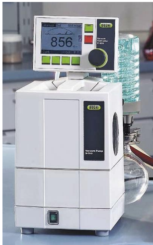
Figura 3. 11: Bomba de vácuo (Buchi, Modelo: Vacuum pump V – 700) utilizada na filtração das amostras.
