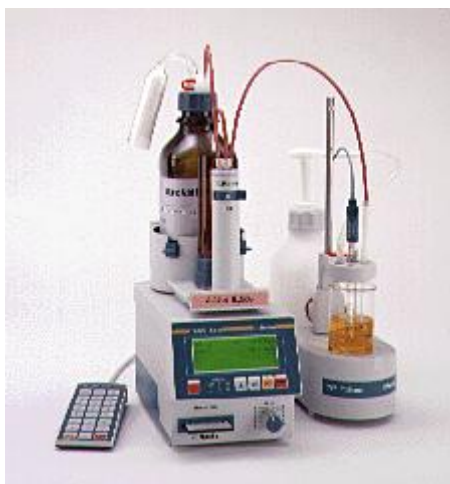
Figura 3.10 Titulador automático (Mettrom, Modelo: Dosimat 665) usado no doseamento do oxigênio dissolvido
