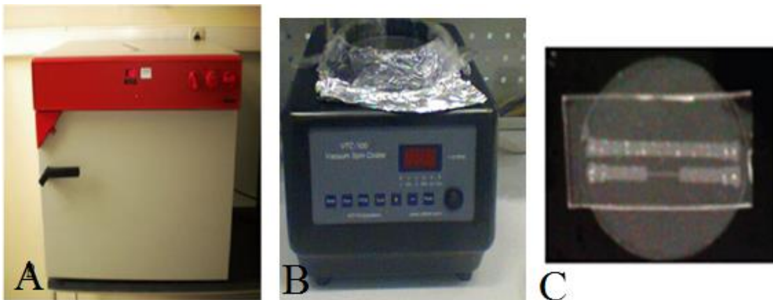
Figura 3.7- a) Forno utilizado para curar o PDMS; b) Spin-coater utilizada para espalhar o PDMS na lâmina; c) Ilustração do resultado da fabricação de microcanais.
