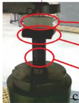
Figura 2.28- Equipamento utilizado nos testes de impacto- Instrumented impact testing machine: ROSAND IFW5HV – Instrumented Falling Weight Impact Tester, type 5 HV : a) montagem do equipamento; b) apresentação do software utilizado; c) Exemplificação da montagem dos materiais.
