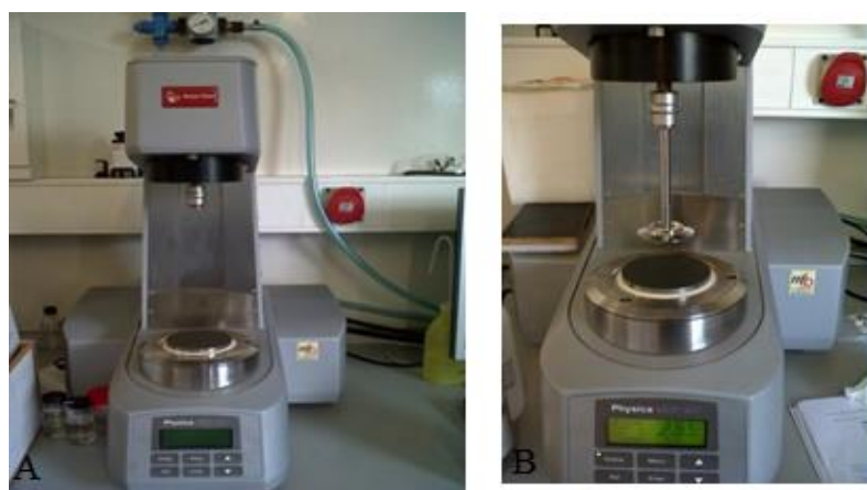
Figura 2.11- a) Reómetro rotacional Anton Paar ; b) Reómetro com a geometria PP50/P2 montada.
