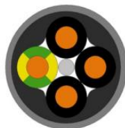
Figura 6-Cabo blindado trifásico, três condutores fase e um terra para alimentação do motor AC.
