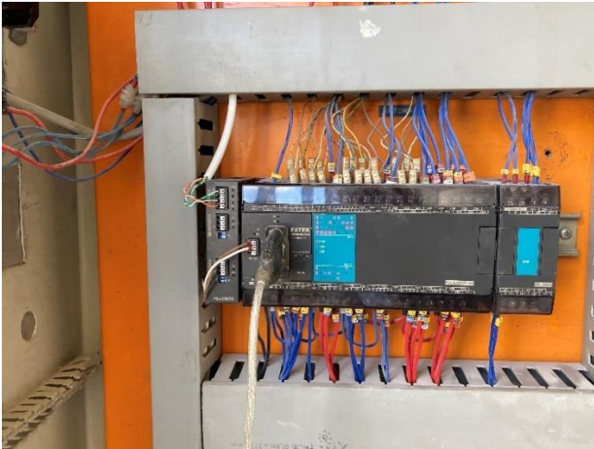
Figura 35 - Carta de comunicação Fatek FBS CM55E instalada no equipamento Minorça.
