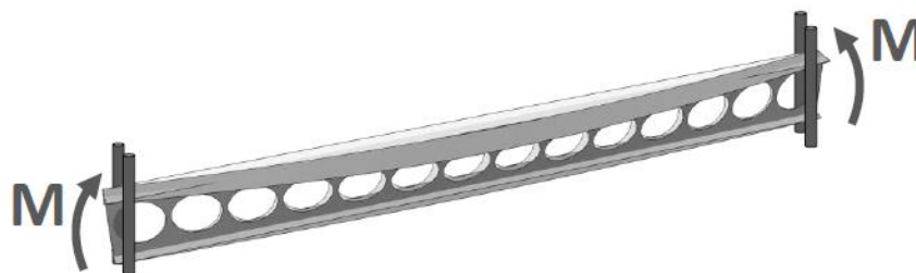
Figura 12 - Encurvadura lateral torsional de uma viga alveolar, [7]
