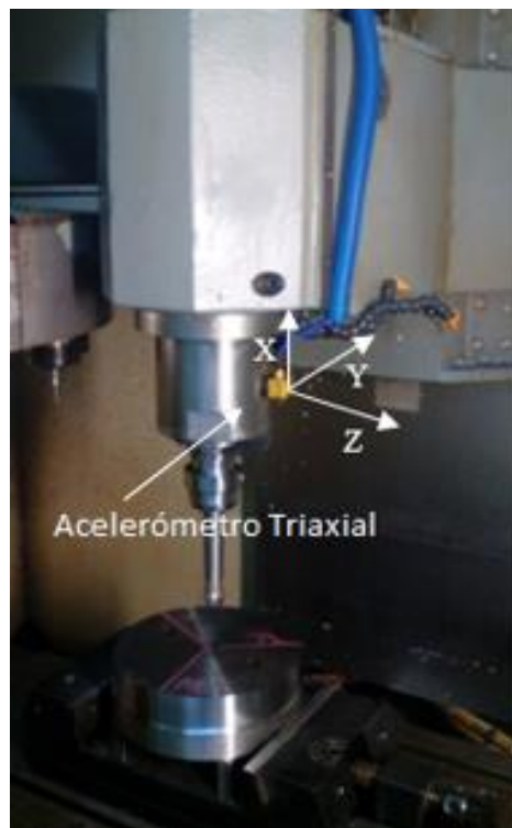
Figura 17: Posicionamento do acelerómetro triaxial para captação das vibrações durante os ensaios, adaptado de [43].
