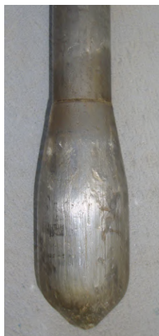
Figura 4 – Vara e ponteira usada no DPSH
