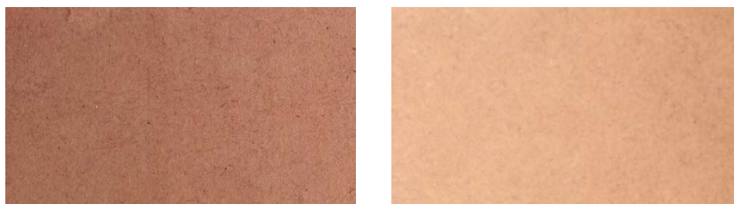
Figura 51 - Perda da coloração nos painéis de MDF-FR: antes do envelhecimento (esq.) e após o envelhecimento (dir.).
