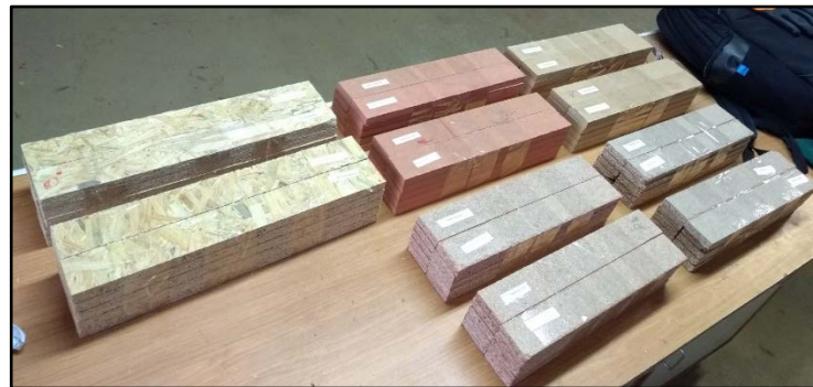
Figura 43 - Obtenção dos provetes após corte das amostras.
