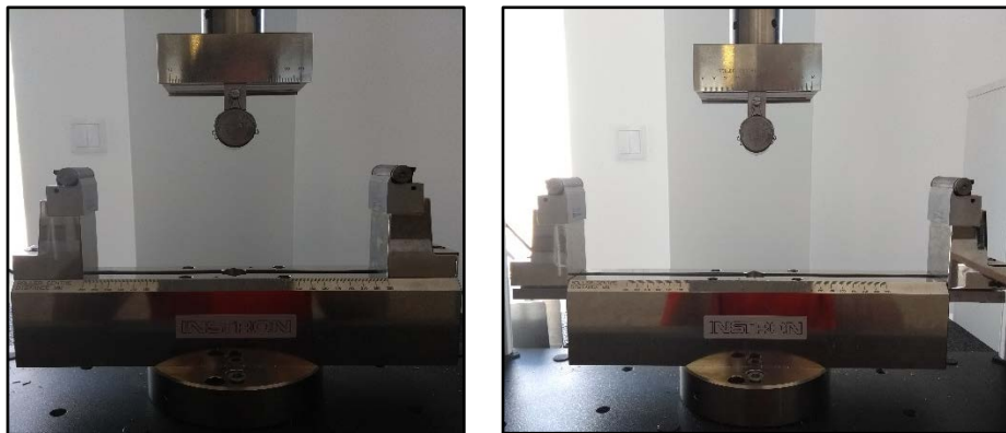
Figura 46 - Distância máxima entre os apoios sem o suporte (esq.) e com o suporte (dir.).
