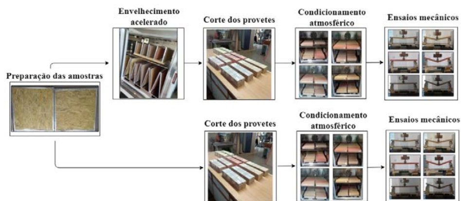
Figura 35 - Representação da sequência utilizada para a caracterização mecânica.
