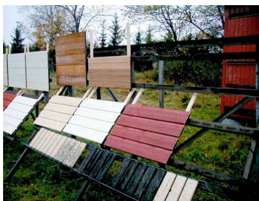
Figura 15 - Envelhecimento natural dos painéis de madeira com retardantes de chama para ambientes externos, expostos a 90° e 45°, [40].
