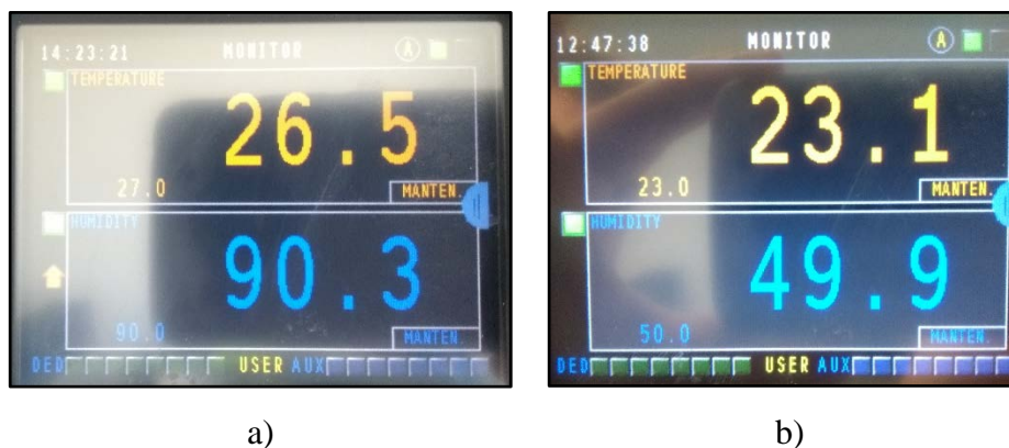
Figura 40 - Painel eletrônico da máquina: a) condições climáticas da 1ª etapa; b) condições climáticas da 2ª etapa.
