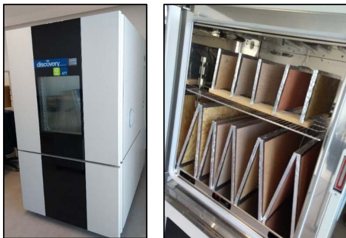
Figura 39 - Máquina ACS DM 600 (esq.), painéis expostos no interior da camara de climática (dir.)
