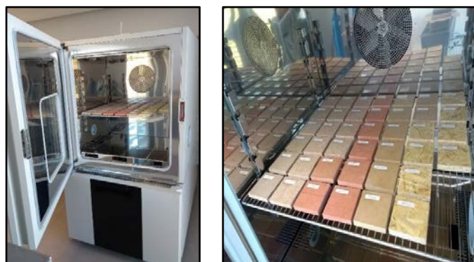
Figura 70 - Condicionamento climático das amostras.
