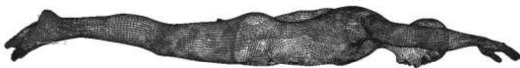
Figura 1. Exemplo da malha de um modelo tridimensional de um nadador para simulações numéricas (avaliações hidrodinâmicas).
