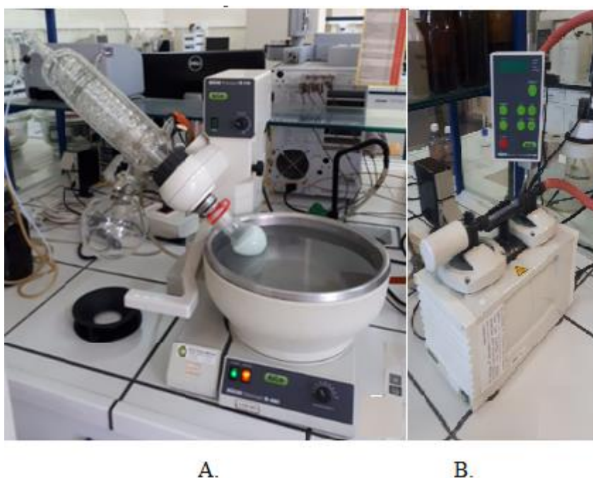
Figura 15- A. Equipamento de Rotavapor com amostra acoplada no banho com aquecimento; B. Compressor de Vácuo.
