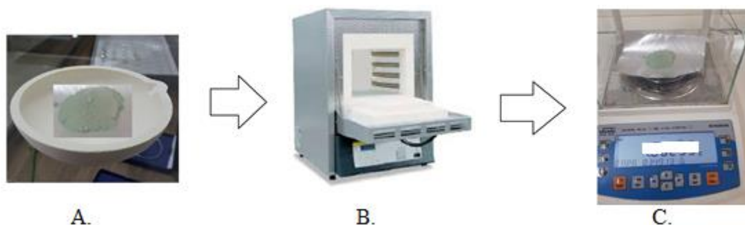
Figura 17 - A. Amostra depositada em almofariz ; B. Mufla; C. Amostra sobre balança para aferição de massa (g)
