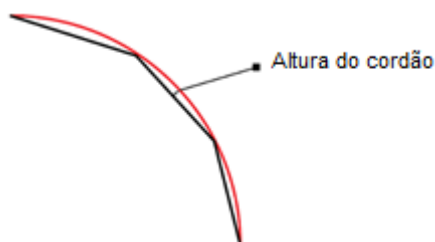
Figura 5 Ilustração da altura do cordão. Adaptado de Giang [19]
