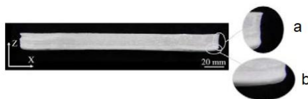
Figura 7 Efeitos de solidificação. a) pincushion e b) curling . Adaptado de [22]
