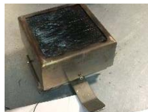
Figura 14: Aspeto final dos provetes sem proteção com fluxo de 75 [kW/m 2 ]
