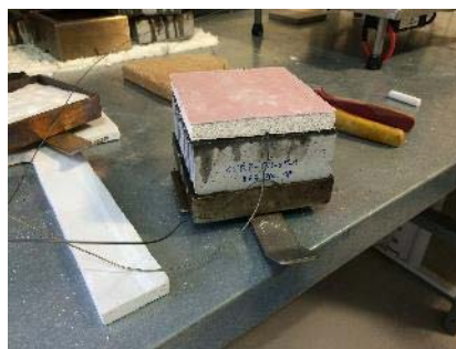
Figura 4: Preparação dos provetes com gesso laminado
