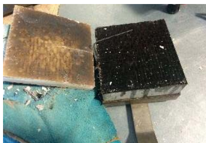
Figura 17: Aspeto final dos provetes protegidos com placa de gesso para um fluxo de 35 [kW/m 2 ]
