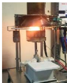
Figura 10: Comportamento do provete sem proteção com fluxo de 35 [kW/m 2 ]
