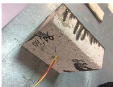
Figura 9: Termopar do tipo K para medição das temperaturas no CFRP
