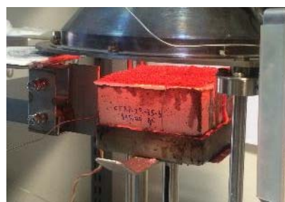
Figura 22: Aspeto final dos provetes protegidos com tinta intumescente para um fluxo de 75 [kW/m 2 ]
