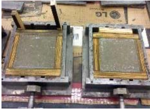
Figura 1: Provetes em betão
