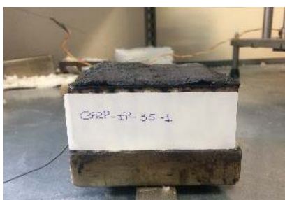
Figura 21: Aspeto final dos provetes protegidos com tinta intumescente para um fluxo de 35 [kW/m 2 ]
