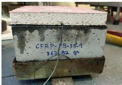
Figura 15: Aplicação dos termopares nos provetes protegidos com placa de gesso
