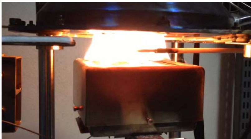
Figura 20: Ignição da tinta intumescente durante o ensaio
