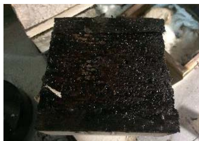
Figura 18: Aspeto final dos provetes protegidos com placa de gesso para um fluxo de 75 [kW/m 2 ]
