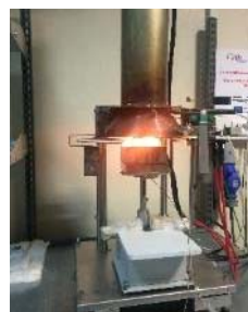
Figura 11: Comportamento do provete sem proteção com fluxo de 75 [kW/m 2 ]
