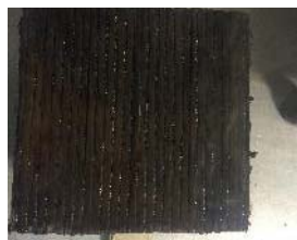
Figura 13: Aspeto final dos provetes sem proteção com fluxo de 35 [kW/m 2 ]
