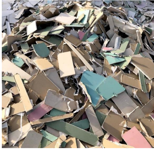
Figura 6 - Gesso cartonado em estação de reciclagem de RCD em Bragança, Portugal.
