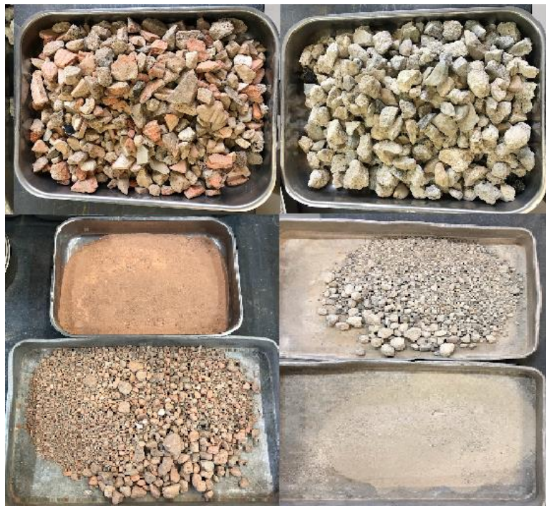
Figura 21 - Amostras antes e depois do ensaio de Los Angeles.
