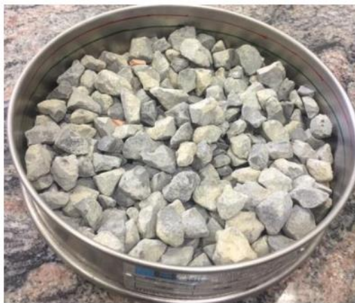
Figura 13 - Agregado reciclado composto por concreto, argamassa e pedra natural.
