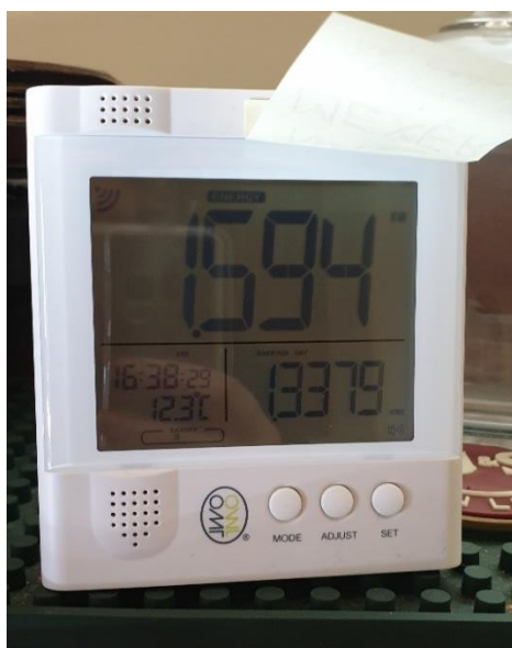
Figura 20. Monitor, onde é possível observar o consumo real da fase em estudo
