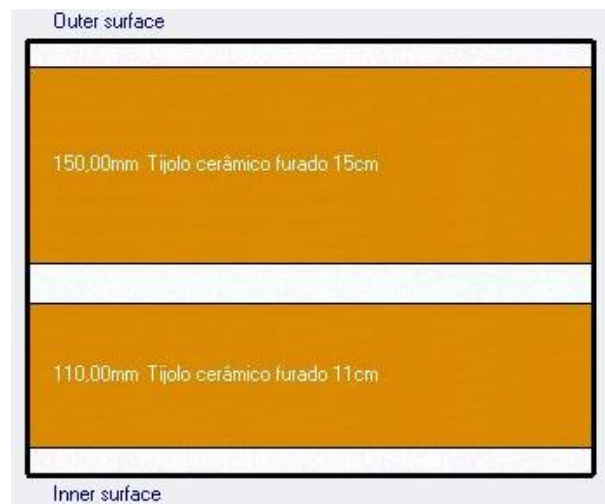
Figura 10. Composição da parede exterior
