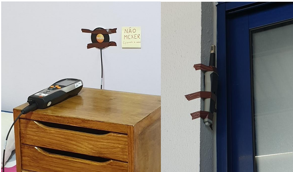
Figura 16. À esquerda, o termofluxímetro com o termopar conectado. À direita, o sensor de temperatura exterior
