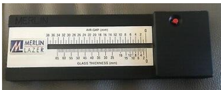
Figura 15. Medidor laser de espessuras do vidro
