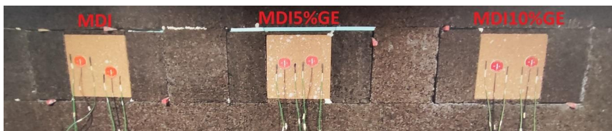
Figura 33 - Painéis MDI com os sensores de fluxo de calor e temperatura instalados.
