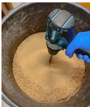
Figura 17 - Mistura dos materiais para a fabricação do aglomerado.
