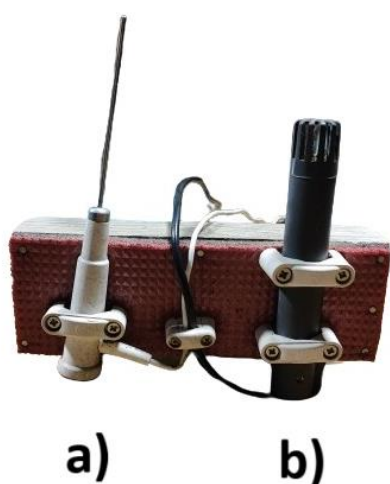
Figura 35 - a) Sonda de temperatura, b) sonda de umidade.
