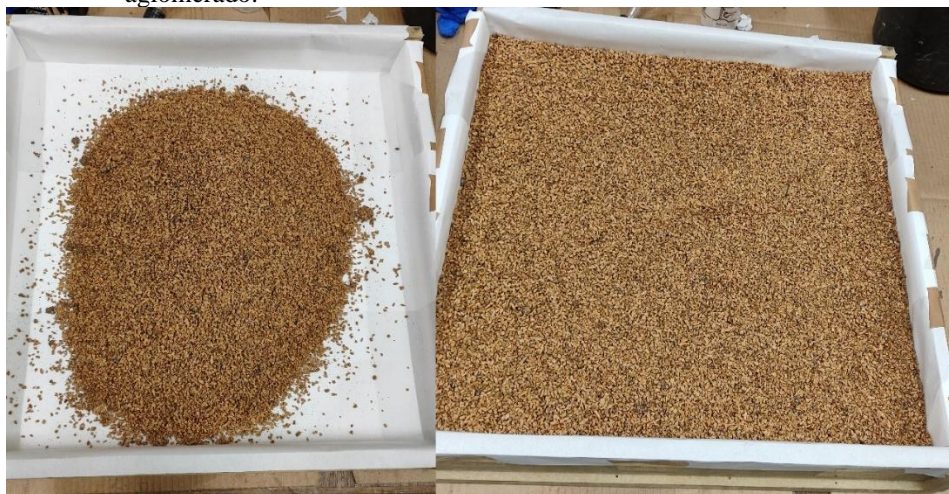
Figura 19 - Distribuição do material no molde.
