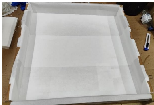
Figura 18 - Molde revestido por papel vegetal.
