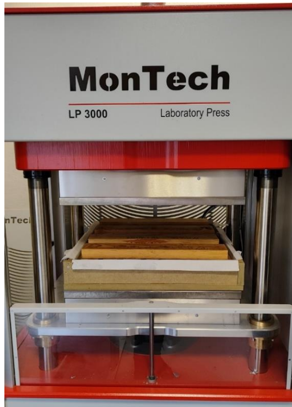
Figura 21 - Processo de prensagem na Prensa Laboratorial MonTech LP3000.
