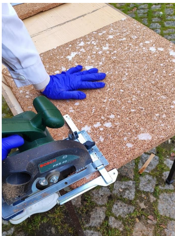
Figura 25 - Utilização da serra circular para o corte das amostras.
