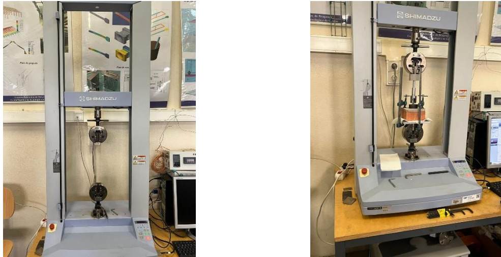
(a) (b) Figura 30 - (a) Equipamento utilizado; (b) Provete no ensaio
