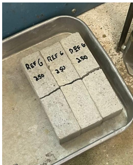
Figura 20 - Provete utilizada no ensaio de compressão
