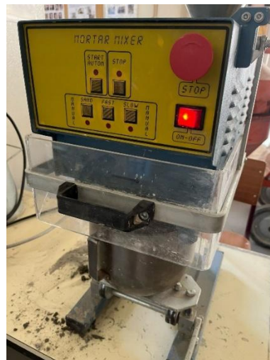
Figura 10 - Misturador no processo de amassadura
