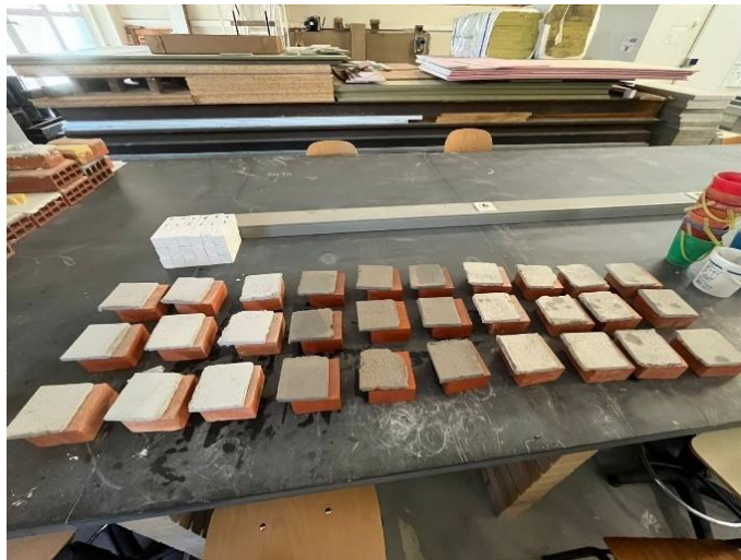
Figura 40 – Provetes com perda de aderência
