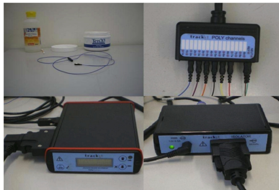
Figura 7 – Hardware de Aquisição (eléttodo e material necessário à sua colocação, pasta condutora, conector de eléttodos, dispositivo principal e sistema de comunicação).
