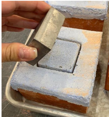
Figura 22 – Demarcação de onde a peça para o ensaio de arrancamento será fixada
