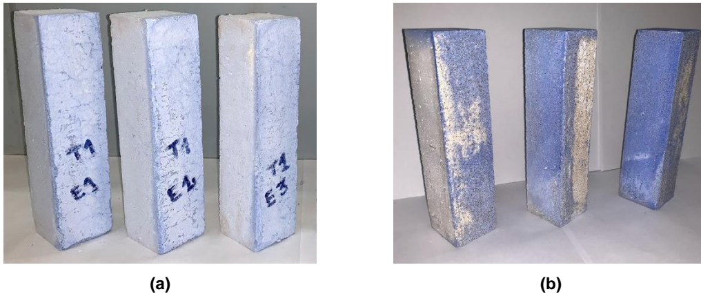
Figura 47 – (a) Composição 1 antes de ser submetida ao envelhecimento artificial - (b) Composição 1 após ser sujeita ao envelhecimento artificial
