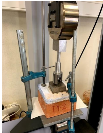
Figura 31 - Ensaio de arrancamento em decurso
