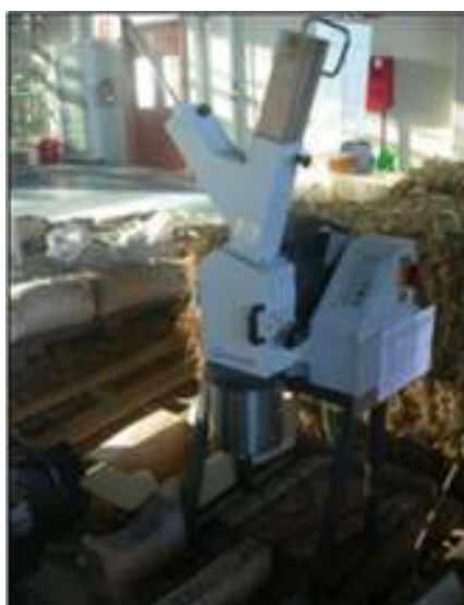
Figura 2.4 – Moínho utilizado na trituração das amostras. (Marca Restch, modelo SM2000).
