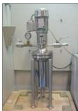
Figura 2.11 – Sistema utilizado na reciclagem química (glicólise).
