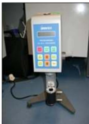
Figura 2.10 – Viscosímetro aplicado na determinação da viscosidade. (Marca Brookfield e modelo LVDV-II)
