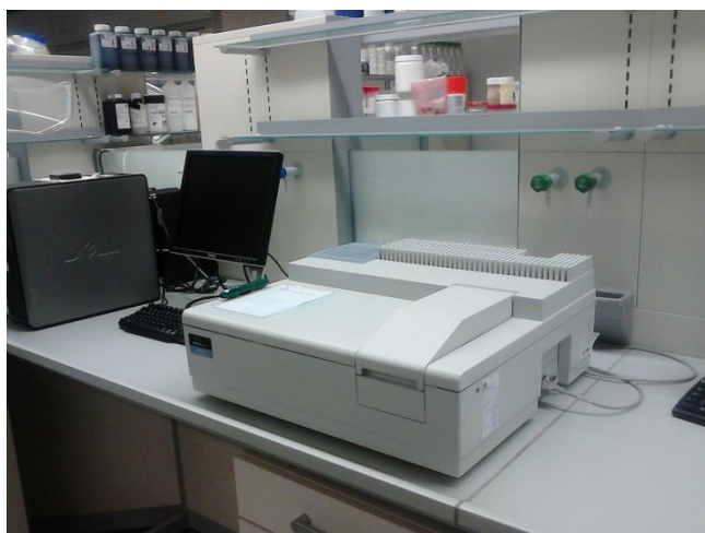
Figura 6. Sistema de espectrofotometria UV-Vis (PerkinElmer) utilizado.
