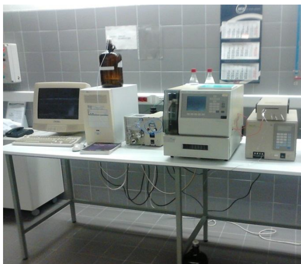
Figura 7. Sistema de cromatografia líquida (Waters) utilizado.
