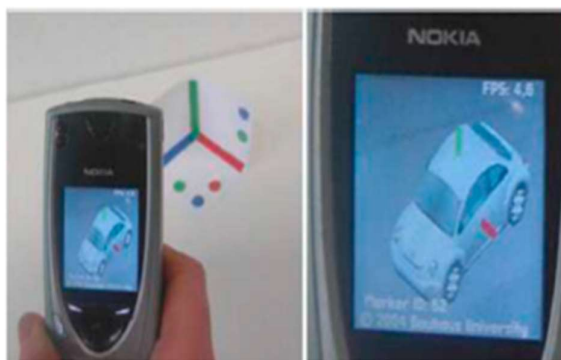
Figura 6: Realidade Aumentada em Dispositivos móveis Fonte: Adaptado de Mohring, Lessig e Bimber (2004)
